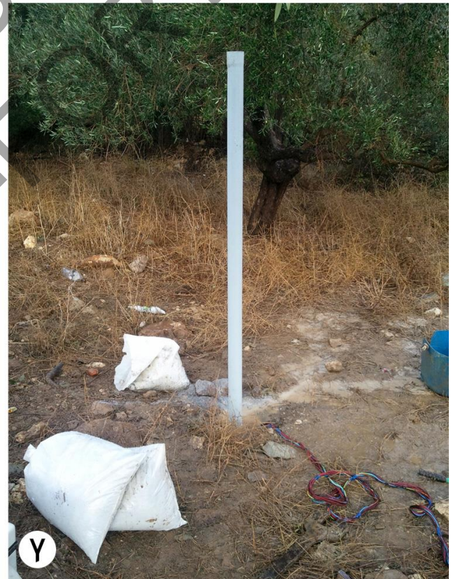
Σχήμα 9. Κατασκευή γεωτρήσεων για την εγκατάσταση ηλεκτροδίων στο εσωτερικό του υπεδάφους (α) με ειδικό μηχάνημα διάτρησης, (β) Τοποθέτηση αισθητήρων με τη χρήση αλουμινοταινίας για αύξηση της αγωγιμής επιφάνειας. (γ) Ολοκλήρωση εγκατάστασης με επιπλέον γέμισμα με μπεντονίτη (σακιά) για καλύτερη επαφή ανάμεσα στους αισθητήρες και στο έδαφος.
