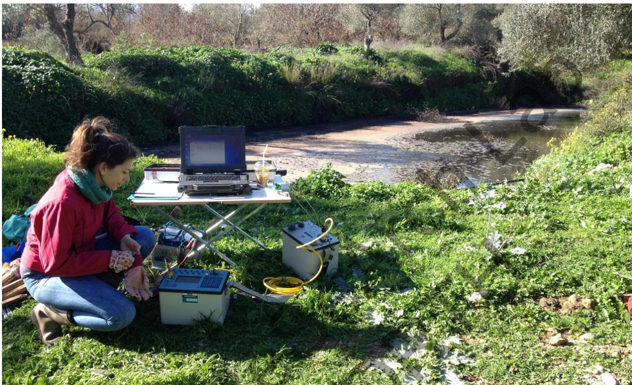
Σχήμα 10. Εξοπλισμός για τη συλλογή δεδομένων ηλεκτρικής αντίστασης (όργανο μέτρησης, υπολογιστής, εξωτερική μπαταρία και καλώδιο ηλεκτροδίων).
