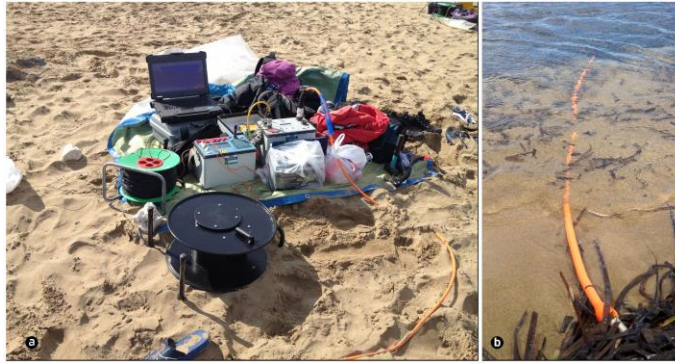
Εικόνα 6. (a) Εξοπλισμός που χρησιμοποιείται σε παράκτιο περιβάλλον, (b) καλώδιο με αισθητήρες (ηλεκτρόδια) που τοποθετείται στη θάλασσα για την λήψη των μετρήσεων.
