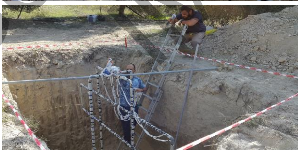
Σχήμα 5: Τοποθέτηση της ιδιοκατασκευής που προσομοιώνει τις τέσσερις κατακόρυφες (W, E, S, N) και τις δύο οριζόντιες (HTop & HBottom) γεωτρήσεις μέσα στο σκάμμα. Στο πάνω μέρος της κατασκευής έχουν τοποθετηθεί οι έξοδοι (μπανάνες) των καλωδίων που συνδέονται αντίστοιχα με τους μεταλλικούς δακτυλίους σε όλες τις πλαστικές σωλήνες.
