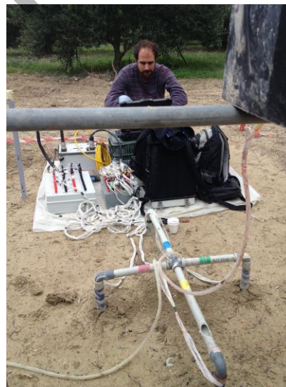
Σχήμα 20: Λεπτομέρεια από την πραγματοποίηση των διαχρονικών πειραματικών τομογραφικών μετρήσεων στο υπαίθριο πεδίο δοκιμών. Στις δύο κάτω φωτογραφίες φαίνεται η ροή του αγώγιμου υγρού από την δεξαμενή στο υπέδαφος μέσω του αλφαδολαστίχου.
