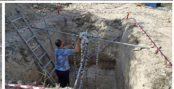
Σχήμα 5: Τοποθέτηση της ιδιοκατασκευής που προσομοιώνει τις τέσσερις κατακόρυφες (W, E, S, N) και τις δύο οριζόντιες (HTop & HBottom) γεωτρήσεις μέσα στο σκάμμα. Στο πάνω μέρος της κατασκευής έχουν τοποθετηθεί οι έξοδοι (μπανάνες) των καλωδίων που συνδέονται αντίστοιχα με τους μεταλλικούς δακτυλίους σε όλες τις πλαστικές σωλήνες.
